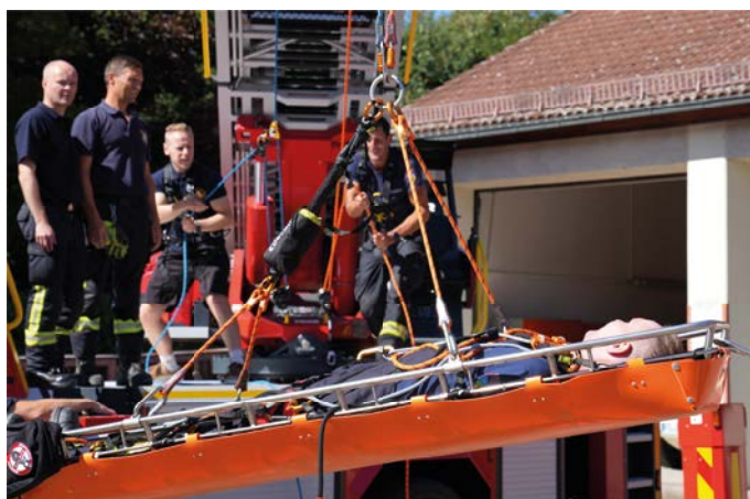
Bei der Produktvorführung wurden Leinen mit Umlenkrollen und Sicherung an der Drehleiter befestigt und eine Person in einer Trage nach oben gezogen.
